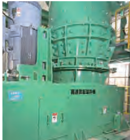
高速回転破砕機 低速回転破砕機で粗く砕かれたごみを選別しやすいようにさらに細かく砕きます。
