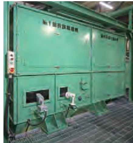
破砕系磁力選別機 磁力の力で鉄類を選別します。
