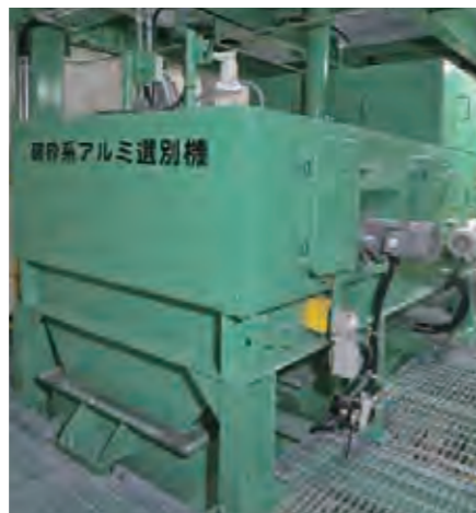
破砕系アルミ選別機 磁石を高速回転し、うず電流を発生させ、反発する原理を利用して、アルミを選別します。
