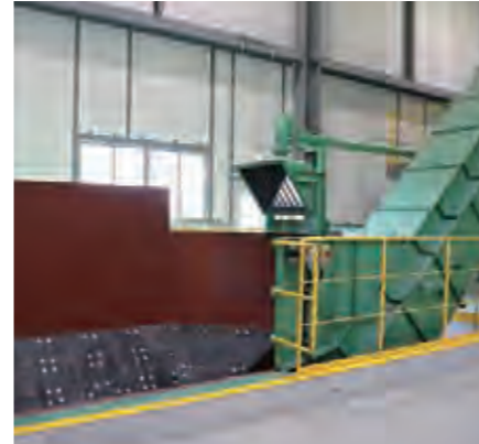
受入ホッパ 搬入されたびん・缶・ペットボトルを選別装置に送ります。
