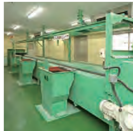
手選別コンベヤ 混入している不適物を人の手によって取り除きます。
