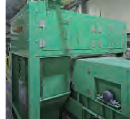
スチール缶選別機 びん・缶類からスチール缶を磁石によって選別します。
