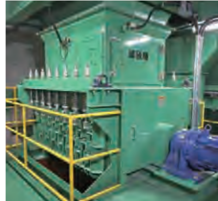
破袋機 袋収集された不燃ごみの袋を破ります。
