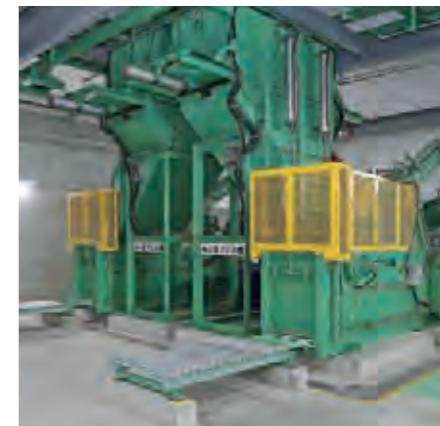
缶プレス機 各選別機で選別されたスチール缶・アルミ缶を圧縮成形します。
