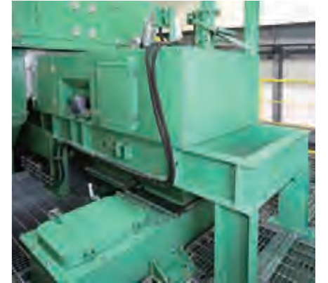
アルミ缶選別機 びん・缶類からアルミ缶を磁石によって選別します。
