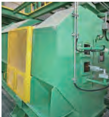
粒度選別機 回転する筒の穴の大きさにより、破砕されたごみを不燃残渣、可燃残渣に選別します。
