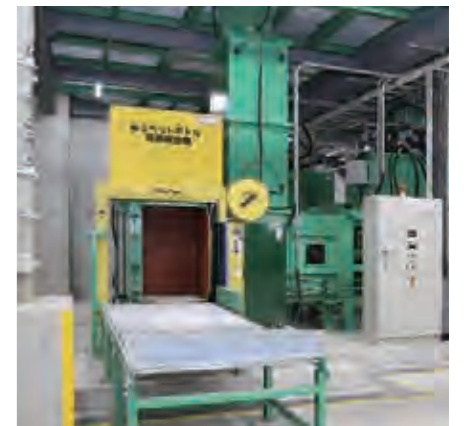
ペットボトル圧縮梱包機 不適物を取り除いたペットボトルを圧縮梱包します。
